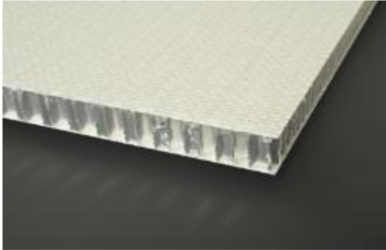
**ESACORE LEM 500** è un pannello leggero composto da nido d'ape d'alluminio e pelli in fibra di vetro impregnata con resina epossidica. Le sue principali caratteristiche sono il peso estremamente basso e le elevate prestazioni meccaniche. È particolarmente adatto all'incollaggio del marmo alleggerito o di altri tipi di rivestimenti lapidei ; il pannello è stato sviluppato sia per la pavimentazione che per la produzione di arredi.
